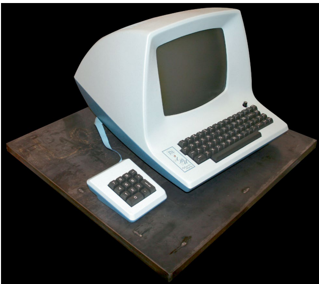
ADM-3A-pääte, Bill Joyn käyttämä Vi-editorin kehitys- ja käyttöympäristö vuonna 1976. Kuva: Chris Jacobs (Wikimedia Commons).
